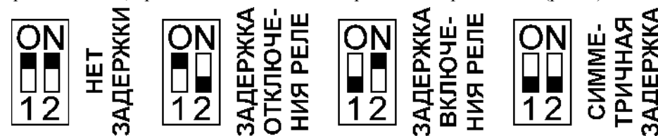
Рис. 4. Внутренние переключатели датчика РДД-02.
